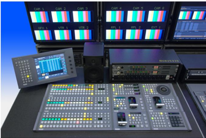
In der Bildregie arbeiten in der Regel der Bildmischer und der Bildingenieur nebeneinander. Alternativ kann ein zweiter Bildmischplatz zwischen diesen beiden Positionen eingerichtet werden, wenn z.B. ein zweiter Feed generiert werden muss. Dafür steht ein zweites Bildmischpult zur Verfügung, welches frei einer Mischebene zugeordnet werden kann.
